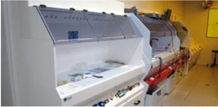
Postes de chimie en salle blanche (environnement contrôlé : poussières, température et hygrométrie) de classe ISO5 dédiés à l'attaque du silicium à l'aide de KOH ou de TMAH (poste au premier plan), à la fabrication de silicium nanoporeux par oxydation anodique (2 e poste) ainsi qu'à la croissance électrolytique des métaux (autres postes).
