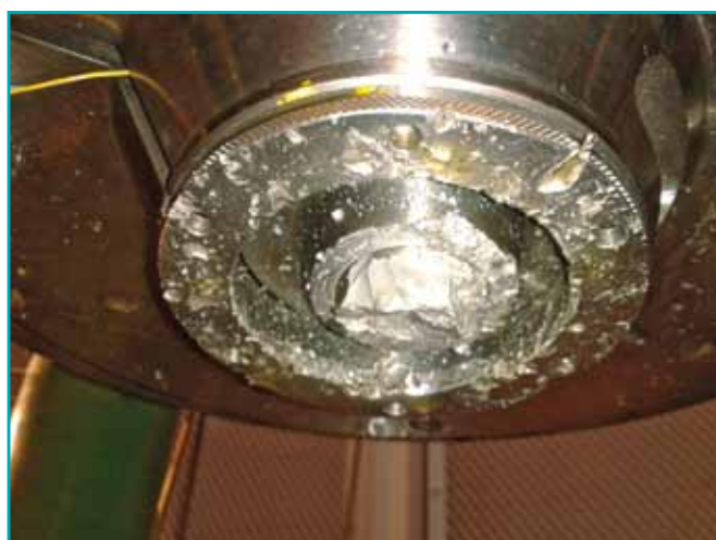
Vue du dispositif en acier de fixation du piston lors de la remontée de la presse.
