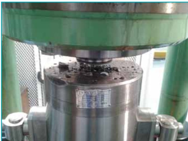
Piston de la presse en position basse après déclenchement de l'arrêt d'urgence par l'opérateur après explosion du piston.
