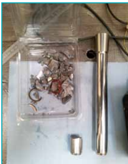
À droite, un piston équivalent à celui détruit lors de l'incident. À gauche, les principaux fragments retrouvés dans l'enceinte de protection.
