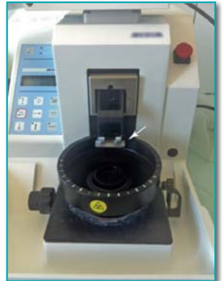
Figure 3 : vibratome dont le support de la lame de rasoir est indiqué par la flèche.
