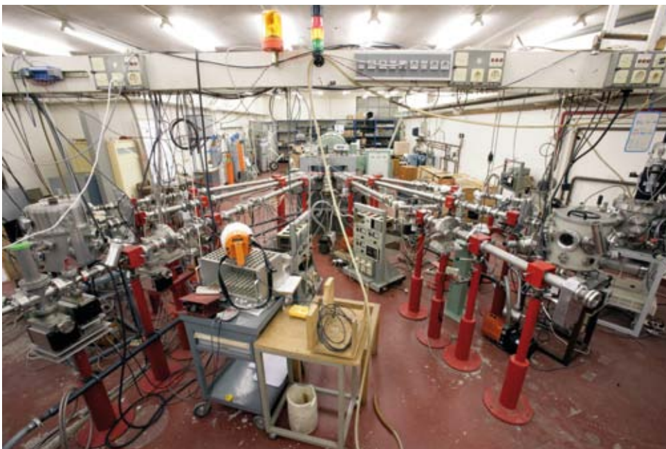
Ensemble de lignes de faisceau sur le système d'analyse par faisceaux d'ions rapides (SAFIR) utilisé pour analyser la composition et la structure cristalline de la région superficielle (1-1000nm) des solides. Des particules légères (protons, deutons, alphas...) produites par l'accélérateur Van de Graaff au fond de la pièce sont envoyées dans les chambres d'analyse. Une analyse des produits de réaction (identité, quantité, spectre en énergie) de ces derniers avec la surface à analyser permet l'identification quantitative des espèces atomiques et isotopiques présentes, de leurs profils de composition, et de la cristallinité de l'échantillon.
