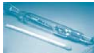
Relais de type Clare dont la tension d'isolement est élevée grâce à la présence d'un gaz haute pression dans l'ampoule.
