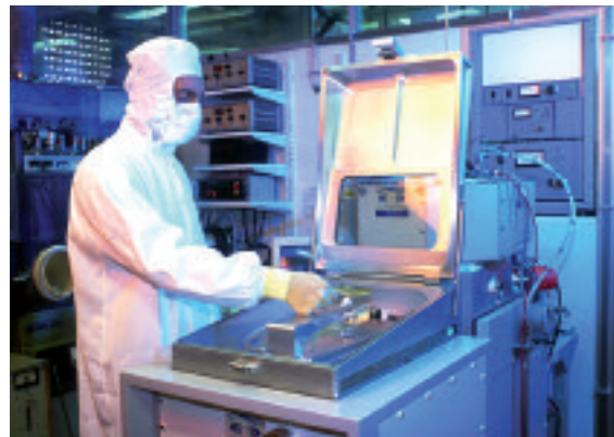
Machine de gravure profonde de silicium utilisée pour les micro-systèmes
