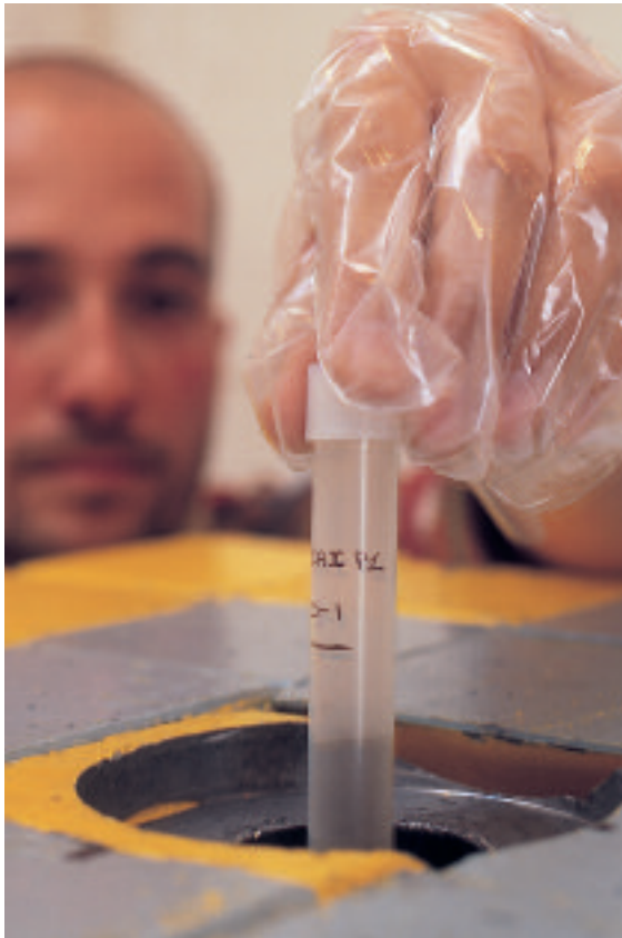
Comptage radioactif avec un détecteur de spectrométrie gamma (puits et château de plomb).
