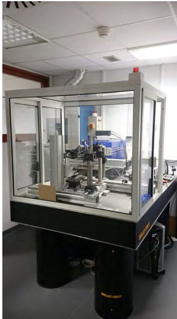
Figure 17 Appareil à laser émettant à 193 nm dans son enceinte de protection en plexiglas (filtrage des UV)
