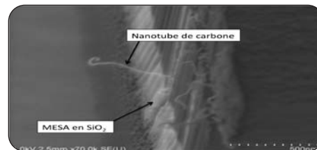
Vue MEB d'une croissance de nanotube insitu sur le composant RF
