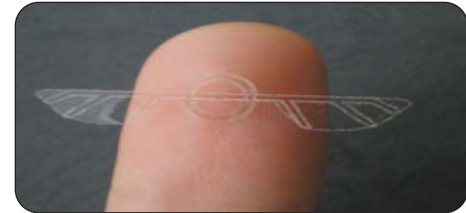
Structure Ailes + Thorax + Tergum réalisées en SU-8
