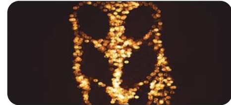
Image IPI de l'écoulement diphasique soumis à une modulation de vitesse f=50 Hz, U=1.2 m/s et u'/U=20\% . Chaque tache circulaire correspond à l'image d'une goutte de décane défocalisée dans la mise au point. A l'intérieur de chaque tache on peut distinguer des franges d'interférences verticales dont le nombre est proportionnel au diamètre de la goutte. Les gouttes qui ont un diamètre de plusieurs dizaines de microns se placent en périphérie des structures tourbillonnaires créées par l'excitation acoustique.
