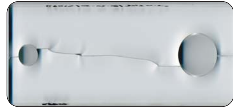
Propagation dynamique simultanément de deux fissures à partir de 2 entailles opposées. Photo post-mortem avec mise en évidence d'un léger évitement avant la rencontre des deux fissures.
