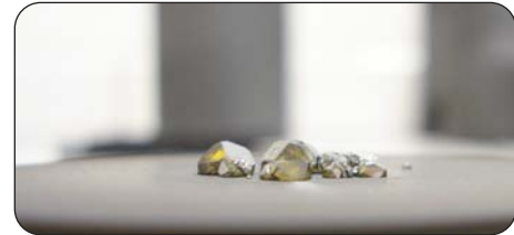
Photographie de cristaux de 3C-SiC obtenus par nucléation spontanée à 2100°C en phase gazeuse (taille moyenne : 4 mm).
