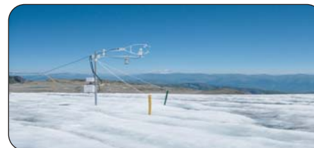
Système de corrélation turbulente : analyseur de gaz LICOR-7500 et anémomètre sonique Campbell CSAT-3, glacier Saint Sorlin, Alpes françaises, juillet 2006.
