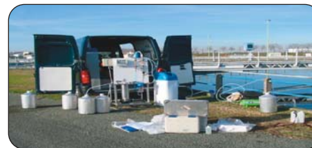
Prélèvement et préconcentration de la MOD à la station d'épuration Seine-Aval
