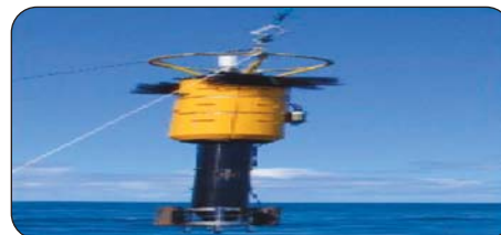
Déploiement du Vertical Microstructure Profiler (VMP) lors de la campagne OVIDE.
