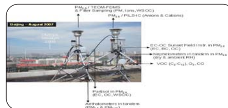
Lignes de prélèvements de la campagne de mesures à Pékin (août 2007)
