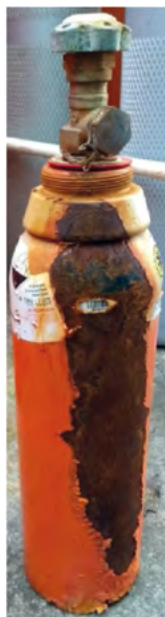
Bouteille HF incriminée dans l'accident lors de l'expertise
