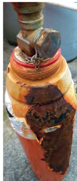
Bouteille HF incriminée dans l'accident lors de l'expertise
