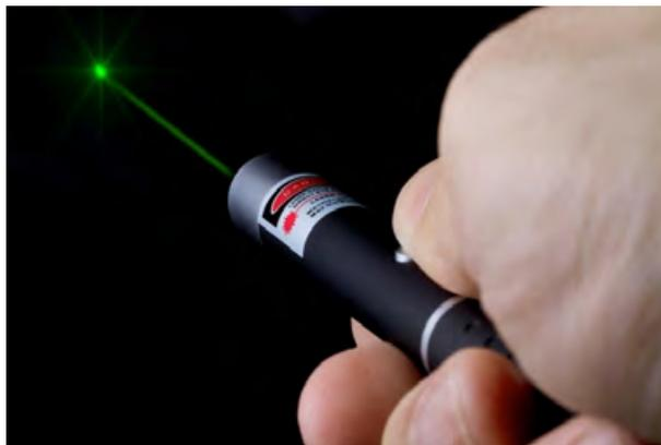
**Figure 10** Pointeur laser adapté à l'enseignement (classe 2)
