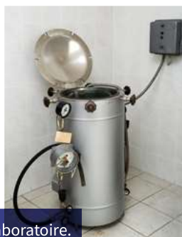
Autoclave de stérilisation de laboratoire.
