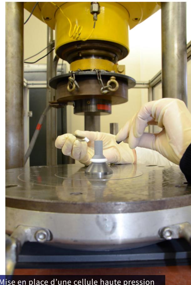
Mise en place d'une cellule haute pression contenant un échantillon, dans une presse Paris-Edimbourg.
