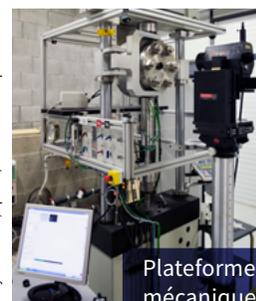
Plateforme HYCOMAT permettant de réaliser différents types d'essais mécaniques (traction, compression, fluage, fatigue, fissuration, décompression explosive) sous pression d'hydrogène, de dioxyde de carbone ou d'azote gazeux. Cette pression peut atteindre 400 bars, entre la température ambiante et 150 °C.
