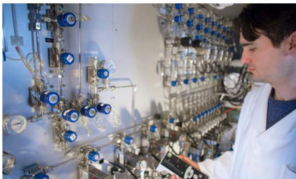
Réalisation d'un test de fuite sur un panneau de gaz d'un bâti d'épitaxie.
