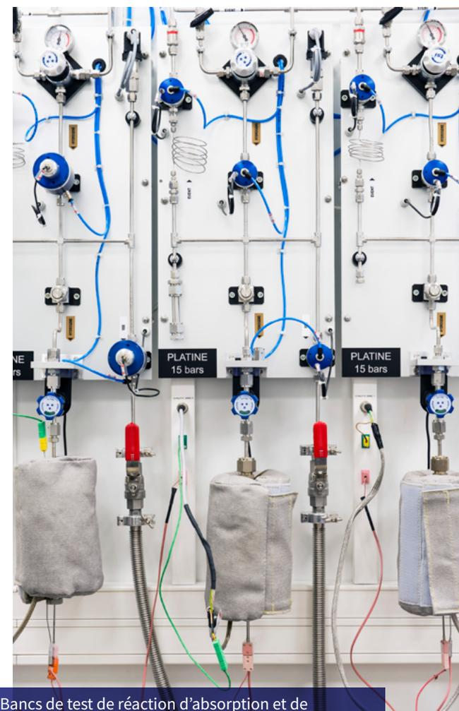
Bancs de test de réaction d'absorption et de désorption à l'hydrogène, en fonction de la pression et de la température.
