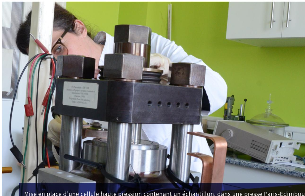
Mise en place d'une cellule haute pression contenant un échantillon, dans une presse Paris-Edimbourg.
