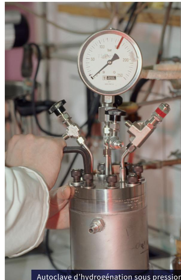
Autoclave d'hydrogénation sous pression.
